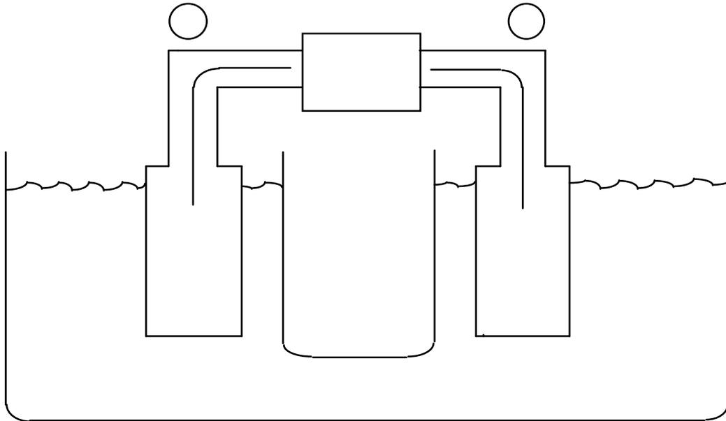
Die pH-Elektrode ist eine Konzentrationszelle mit **semipermeabler Membran**, die ausschließlich  $\text{H}_3\text{O}^+$ -Ionen passieren läßt. Die elektrische Spannung wird nicht an den Elektroden, sondern ähnlich wie in den Nervenzellen bereits an dieser semipermeablen Membran erzeugt. (**wie?**) Die Bezugslösung muß nicht erneuert werden. (**warum?**)
