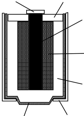
An der Anode wird Zink zu  $\text{Zn}^{2+}$  \_\_\_\_\_. An der Kathode wird Braunstein  $\text{MnO}_2$  zu Manganoxidhydroxid  $\text{MnO}(\text{OH})$  \_\_\_\_\_. Dabei werden Protonen  $\text{H}^+$  verbraucht, die durch den sauren Elektrolyten (mit Zellulose angedickte Ammoniumchlorid-Lösung) zur Verfügung gestellt werden:
