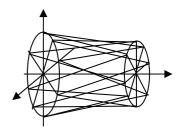
Schneidet man den so konstruierten Rotationskörper mit der Zeichenebene  $(x_1-x_2$ -Ebene), so erhält man eine konkave Begrenzungskurve für die Schnittfigur. Diese **Mantellinie**  $\mathbf{r}(\mathbf{x})$  lässt sich als **gedrehte Hyperbel** beschreiben:
