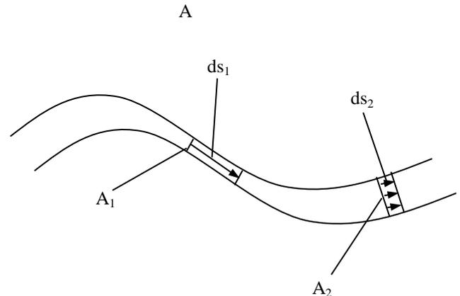
**Kompressible Gase** werden an engen Stellen zusammengedrückt, d.h. es gehen immer noch gleich viele Teilchen pro Zeit durch den kleinen Querschnitt, aber sie benötigen weniger Raum. Der Massenstrom  $\dot{m} = \rho \cdot \dot{V}$  bleibt konstant aber die Dichte  $\rho$  nimmt zu und der Volumenstrom  $\dot{V}$  nimmt ab.
