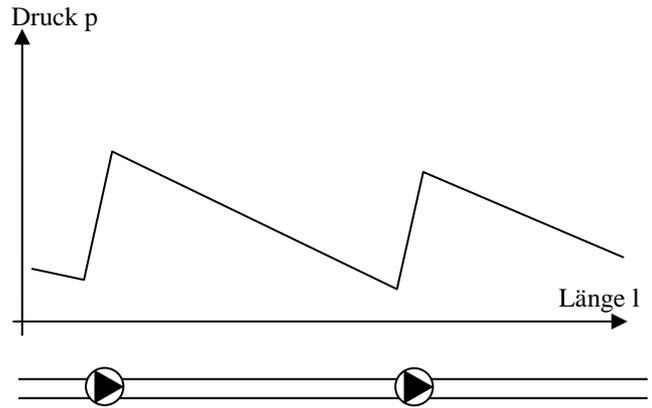
Druckverlauf in einem langen Rohr mit Pumpen
