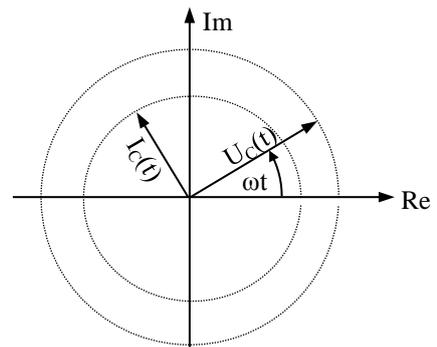
Für die **Spule** mit Induktivität  $L$  ist  $I'(t) = \frac{U(t)}{L} = \frac{U_0}{L} \cdot e^{i\omega t}$  mit der
