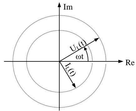
**Imaginäre Impedanzen von Induktivitäten und Kapazitäten heißen auch Blindwiderstände, da sie keine Arbeit leisten:** Arbeit wird nämlich nur verrichtet, wenn Ladungen unter Kraftaufwand (Spannung) in Bewegung (Strom) gesetzt werden. Sind Strom und Spannung um  $90^\circ$  phasenverschoben, so schwingen die Ladungen nur hin und her, wobei wie bei einer Schaukel die bei einer Viertelperiode abgegebene Arbeit in der nächsten Viertelperiode gleich wieder aufgenommen wird.
