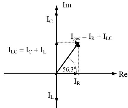
Die maximale Gesamtstromstärke ist  $I_{ges} \approx 1,85 \text{ A}$  mit Phasenverschiebung  $\varphi \approx 56,3^\circ$  (Strom läuft vor).
