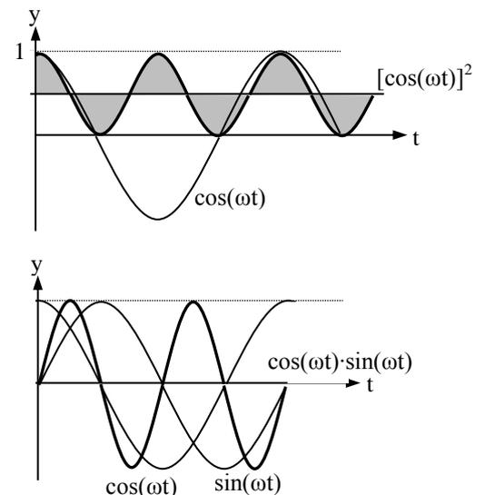
Wie in 3.5.2. schon erwähnt, kann nur die Komponente  $I(t) \cdot \cos(\varphi)$  des Gesamtstromes  $I(t)$ , die in Phase mit der Spannung  $U(t)$  ist, Arbeit leisten. Nur diese Wirkleistung  $P_W = U_{\text{eff}} \cdot I_{\text{eff}} \cdot \cos(\varphi)$  wandelt kontinuierlich elektrische Leistung in **mechanische oder Wärmeleistung** um. Sie ist maximal, wenn die **Phasenverschiebung**  $\varphi = 0^\circ$  ist und minimal, wenn sie  $90^\circ$  ist.
